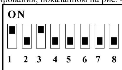
Рис. 4. Пример установки адреса БУЗ
