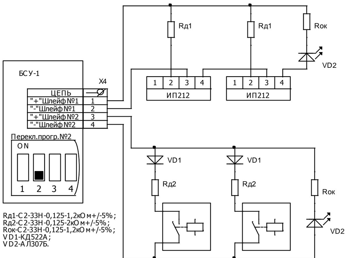
Рис. 7. Схема подключения шлейфа с активными пожарными извещателями
