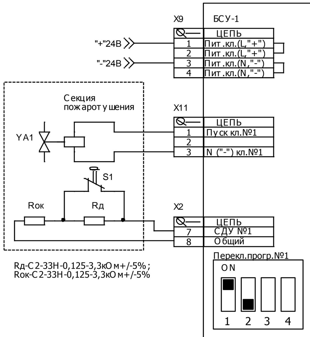
**Рис. 15. Схема подключения узла управления секцией пожаротушения**
