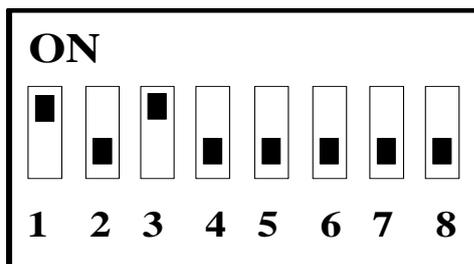
**Рис. 3. Пример установки адреса БСУ**
