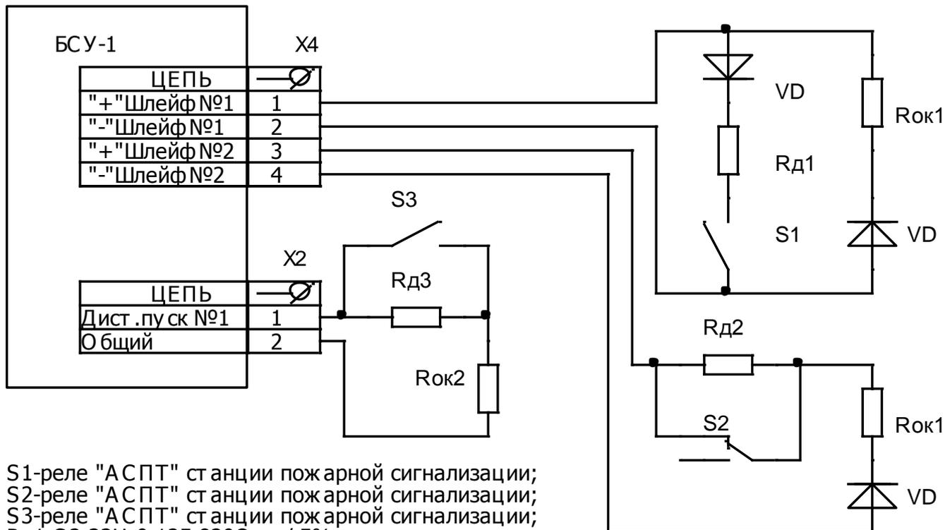
S1-реле "АСПТ" станции пожарной сигнализации;
