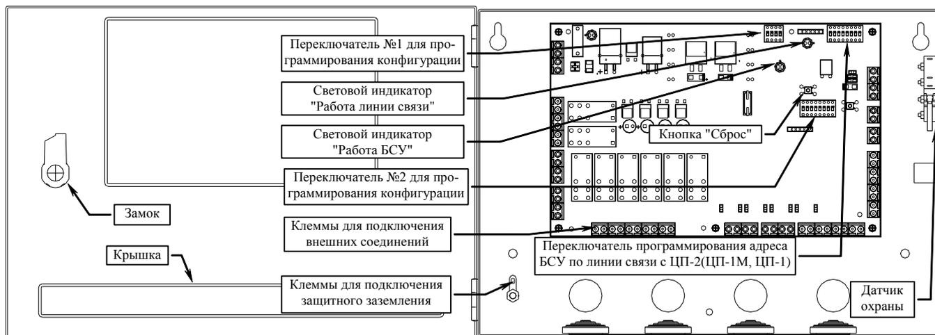
Рис. 2. Расположение блоков в БСУ
